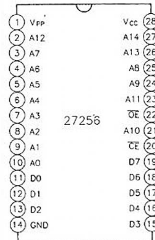
Рис. 3.26. Система выводов ППЗУ 27256
