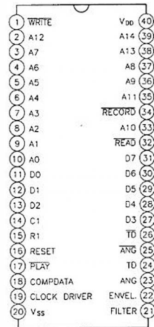
Рис. 3.14. Схема выводов UM5100
