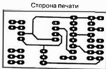
Рис. 4.31. Топология печатной платы электронного ключа
