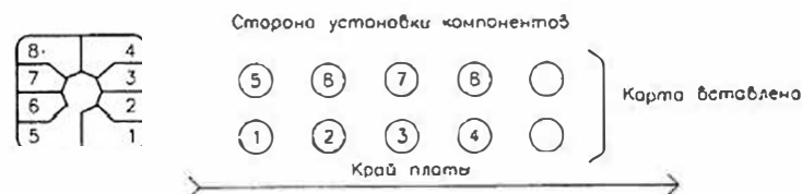
Рис. 4.4. Соответствие между выводами
